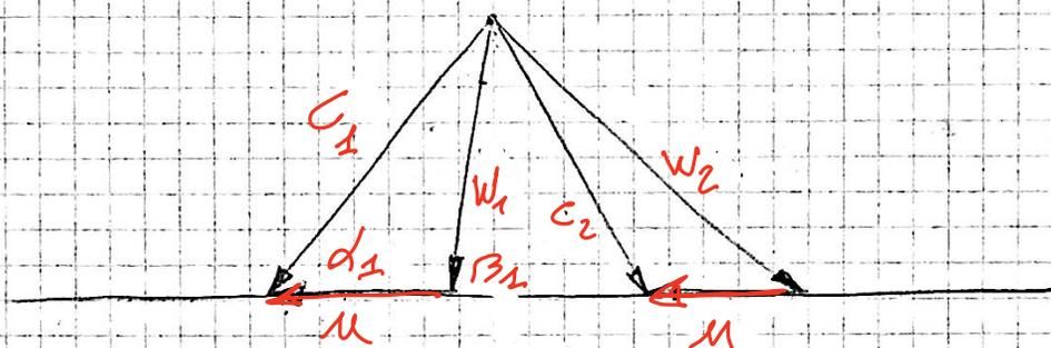
$\beta_1$  è l'angolo che deve essere dato alla paleatura all'ingresso in modo che il fluido entri nel rotore senza urtare le pale - [ altrimenti o nell'estrazione o nell'iniezione si creerebbero depressioni ].
