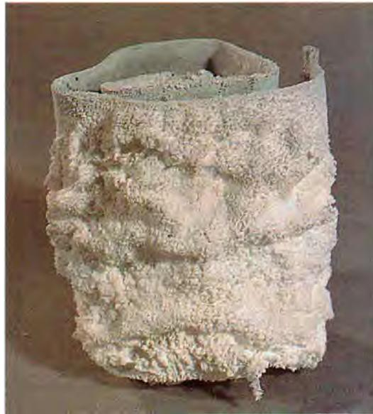
Questa lamina di piombo, esposta a vapori di acido acetico e di biossido di carbonio in presenza di aria e umidità, si è coperta di uno strato di carbonato basico di piombo (bianco di piombo, chiamato anche biacca), pigmento senza il quale la stessa pittura a olio non avrebbe potuto esistere.
